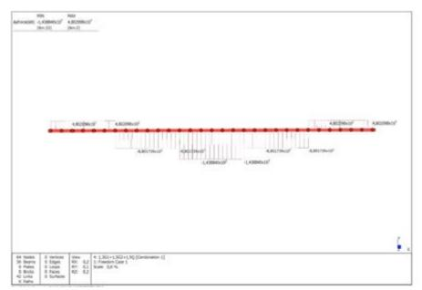
Figura 7. Diagramma dello sforzo normale sulla soletta superiore prodotto dalla combinazione di carico allo SLU 1,3\*G1+1,5\*G2+1,5\*Q
