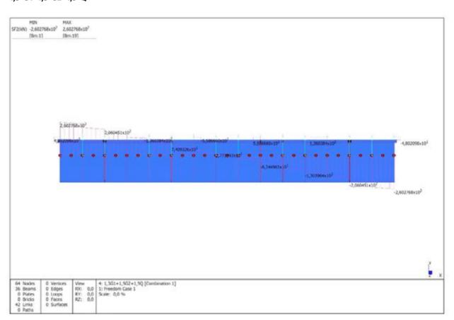
Figura 6. Diagramma del taglio sul rinforzo inferiore prodotto dalla combinazione di carico allo SLU 1,3\*G1+1,5\*-G2+1,5\*Q
