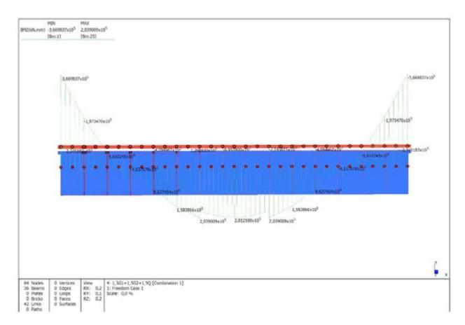
Figura 5. Diagramma del momento flettente sul rinforzo inferiore prodotto dalla combinazione di carico allo SLU 1,3\*G1+1,5\*G2+1,5\*Q
