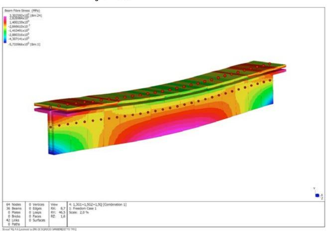
Figura 3. Contour delle tensioni longitudinali prodotte dalla combinazione di carico allo SLU 1,3\*G1+1,5\*G2+1,5\*Q
