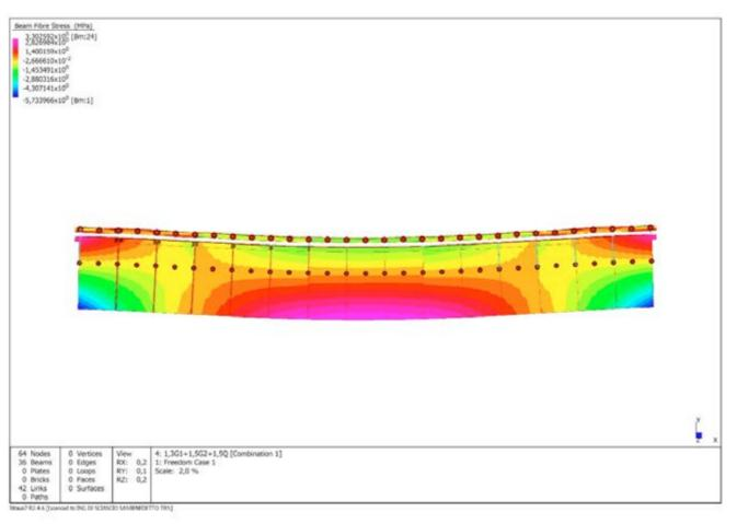
Figura 4. Contour delle tensioni longitudinali prodotte dalla combinazione di carico allo SLU 1,3\*G1+1,5\*G2+1,5\*Q
