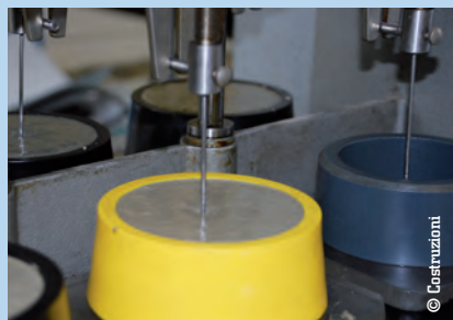
La formella in cui si determinano i tempi di presa.
