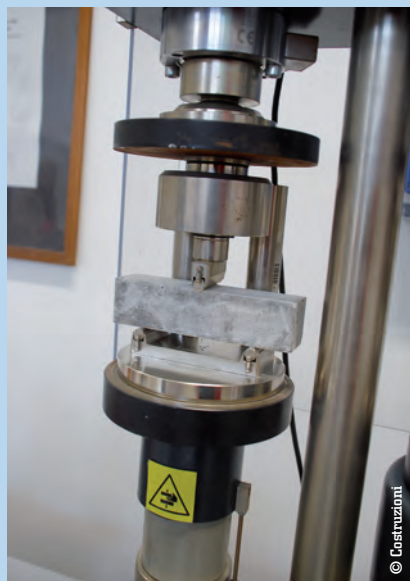
Il test di rottura a flessione, prima e dopo la rottura dei provini.
