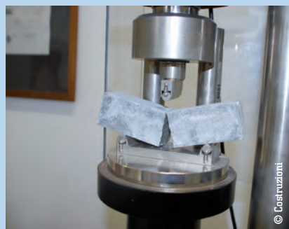
Il test di rottura a flessione, prima e dopo la rottura dei provini.
