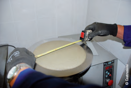
La prova dello spandimento che testa l'efficacia dell'additivo, valutando la sinergia tra additivo e cemento.
