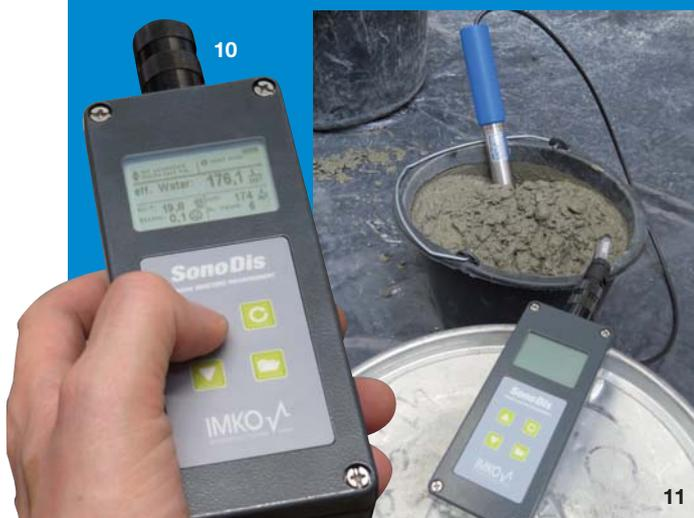
10, 11. Test di misurazione dell'umidità del calcestruzzo fresco con igrometro mobile.
