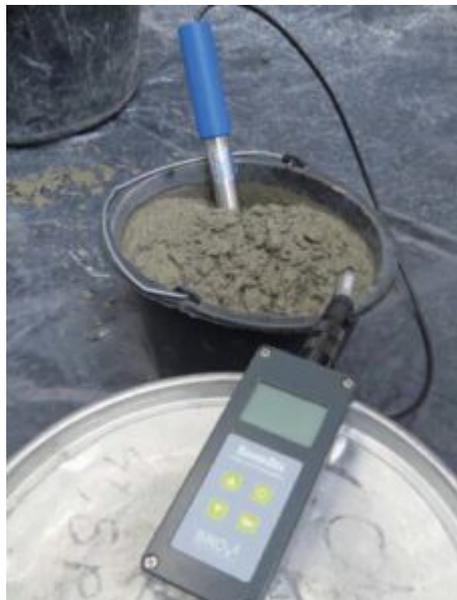
Test di misurazione dell'umidità del calcestruzzo fresco con igrometro mobile
