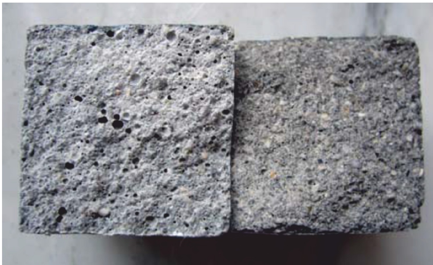
Foto dei provini di cemento con e senza additivo Aeternum 1 NG lasciati maturare in acqua di mare e potabile.
