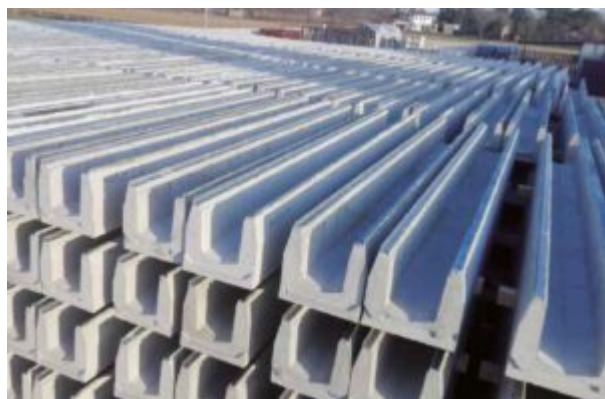
Canali in calcestruzzo armato pronti per il trasporto
