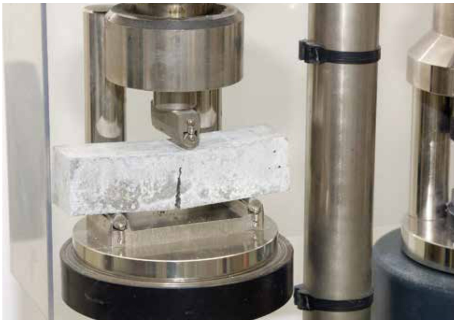
Aeternum HTE: Prova di flesso-trazione in corso
